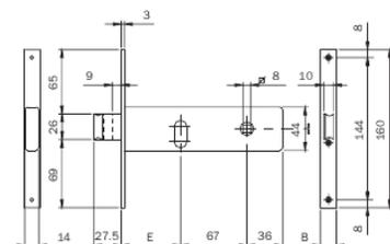
Serratura per fascia. CHIUSURA LATERALE. Funzionante con cilindro ovale. Scatola H 44 ZINCATA.
