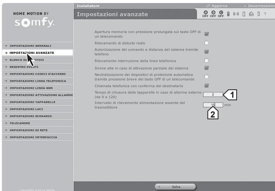
**1** Temporizzazione delle tapparelle legata al funzionamento del sensore di movimento esterno
