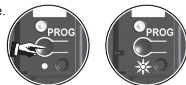
**Tutti i dispositivi dell'impianto vengono eliminati** dalla centrale/trasmittitore, anche il codice installatore.
