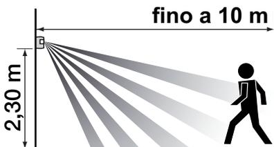
I sensori di movimento rilevano qualsiasi spostamento e qualsiasi variazione di temperatura dovuti a un corpo in movimento.
