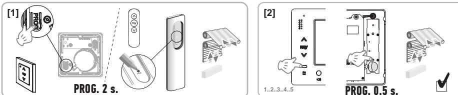
Anmerkung: Zum Löschen der Programmierung des Funksenders der Innenstation auf einem io-homecontrol®-Empfänger wiederholen Sie bitte die oben beschriebenen Schritte.
