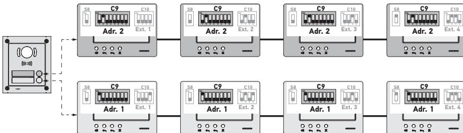
NB: in caso di utilizzo di un modulo esterno con più pulsanti di chiamata (opzione disponibile nel 2017), i monitor devono essere configurati con un indirizzo diverso per ogni alloggio.
