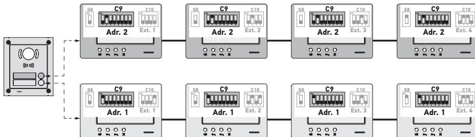
Nota : en cas d'utilisation d'un module extérieur à plusieurs boutons d'appel (option disponible en 2017), les moniteurs doivent être paramétrés avec une adresse différente par logement.
