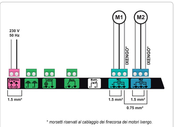
\* morsetti riservati al cablaggio dei finecorsa dei motori Ixengo.
