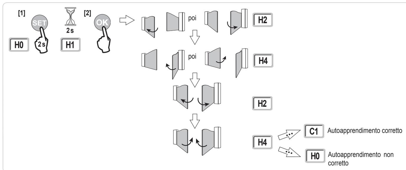
**1** È possibile accedere alla modalità di autoapprendimento in qualsiasi momento, anche quando il ciclo di autoapprendimento è già stato effettuato e sul display appare "C1".
