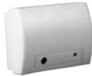
Rileva la frequenza acustica di rottura del vetro e lo scarto di pressione tra l'interno e l'esterno dell'abitazione. Protegge unicamente i vetri affacciati verso l'esterno.
