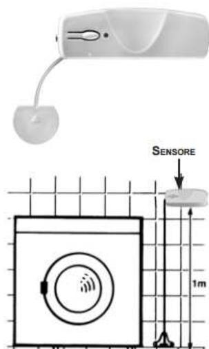
**1** Fissare il supporto della sonda alla parete e a raso terra.
