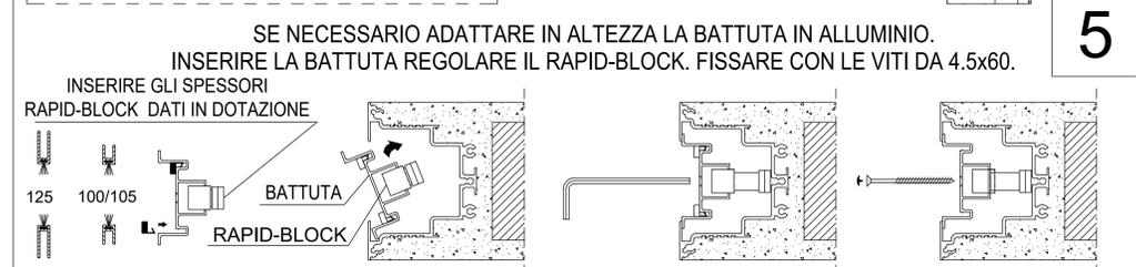
SE NECESSARIO ADATTARE IN ALTEZZA LA BATTUTA IN ALLUMINIO. INSERIRE LA BATTUTA REGOLARE IL RAPID-BLOCK. FISSARE CON LE VITI DA 4.5x60.
